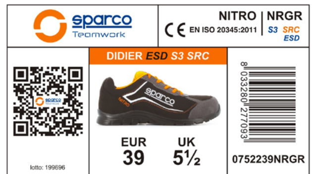
ETICHETTA ESTERNA SCATOLA applicata sul lato predisposto della scatola, riporta le caratteristiche del prodotto, Certificazione, numero di lotto, codice prodotto, codice QR e codice a barre. Dimensioni 105x60 mm
